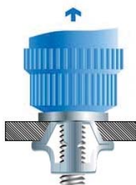
Il tirante sviluppa una trazione; il fusto si comprime deformandosi sotto il supporto.
