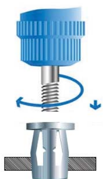
Avvitare l'inserto sul tirante della traininserti.
