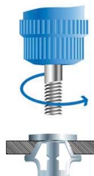
Il tirante viene svitato dall'inserto applicato.
