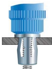
Introdurre l'inserto nell'alloggiamento del supporto.
